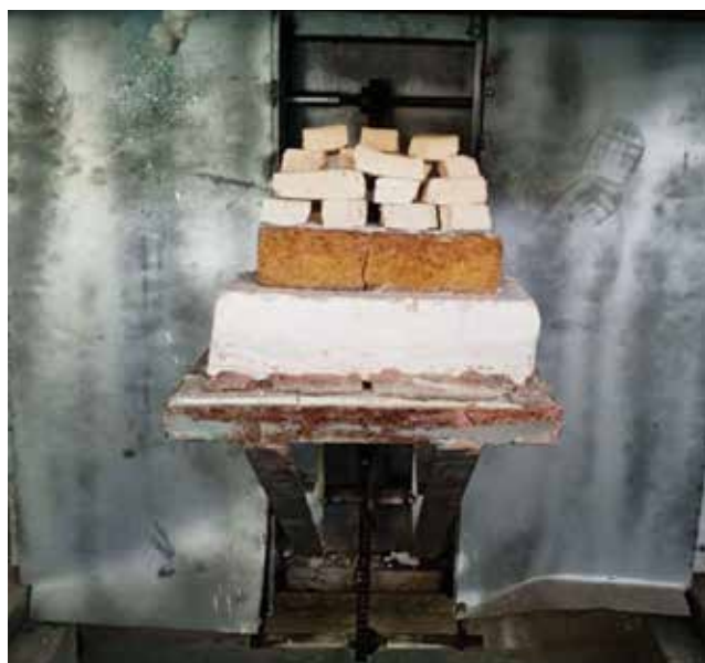
Hình 4. Lò và mẫu quặng magnesite chuẩn bị vào nung.
