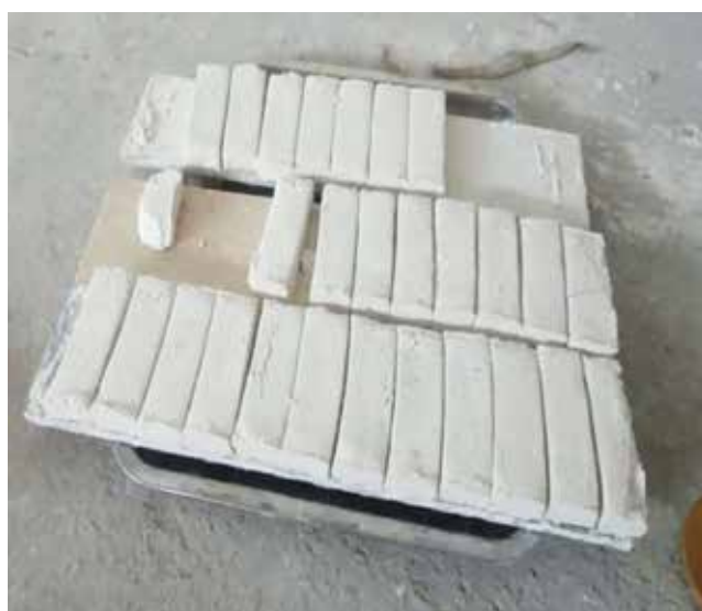
Hình 3. Quặng magnesite sau khi đóng bánh.
